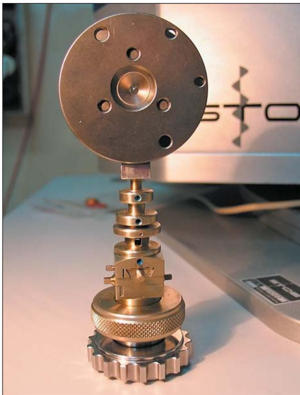
Рис.1. Современная ячейка с алмазными наковальнями для создания высоких давлений, закрепленная на стандартной гониометрической головке дифрактометра.
